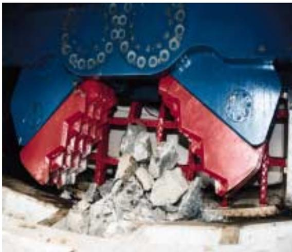
*Fig. 4 : Jaw crusher*
