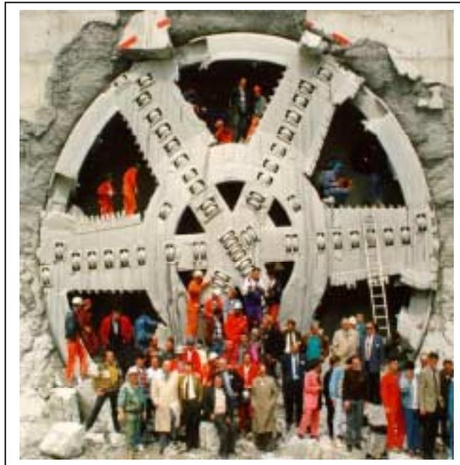
*Fig.17: Convertible Mixschild for Grauholztunnel / Switzerland / ( $\varnothing$  11,6 m)*
