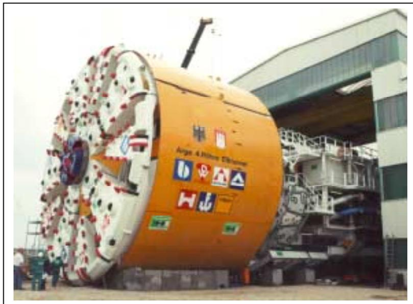
*Fig. 18: Mixschild for Hamburg / Germany / ( $\varnothing$  14,2 m)*
