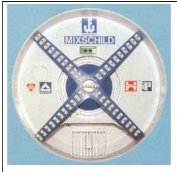
*Fig. 13: First Mixschild Hamburg Hera ( $\varnothing$  5,95 m)*
