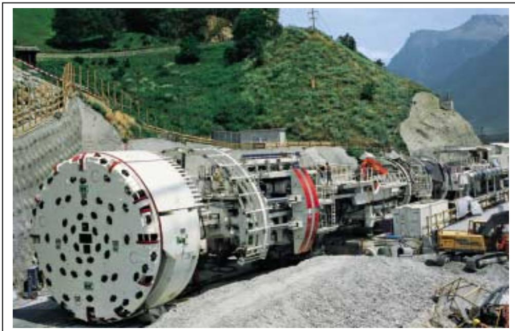
*Fig. 17: Single gripper-TBM Raron / Lötschberg  $\varnothing$  9.43 m*
